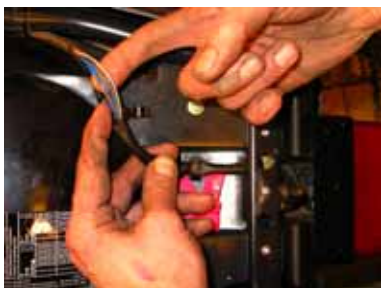
Die elektrische anschlüsse an das Motorrad werden in der nähe von das Rücklicht durchgeführt. Nehmen Sie die Sitze von das Motorrad, und suchen Sie die Leitungen für Blinker und Licht. Nehmen Sie sicherheitshalber der Minusleitung von der Motorradbatterie. Schneiden Sie ganz vorsicht die
