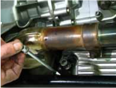
Der M12 Schraube bei der Hauptständer befestigung (Anzugmoment 72 Nm),
